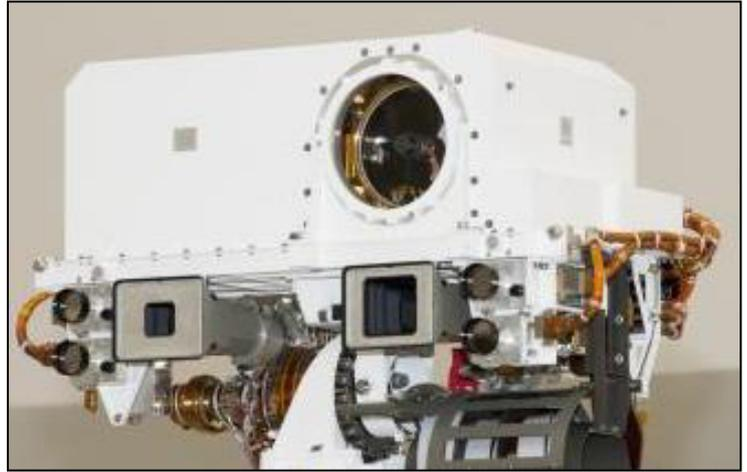
La cámara de la derecha o Mastcam-100 posee un teleobjetivo de 100 mm de focal capaz de alcanzar una resolución de 7,4 cm x píxel a 1 Km de distancia, cada imagen tiene un campo de 6° x 5°.
